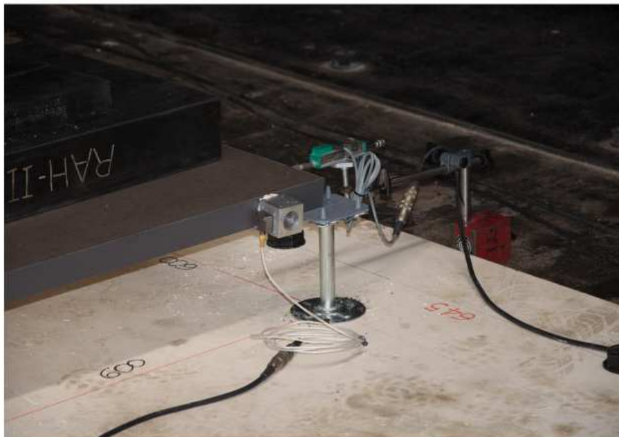
Figura 6 Trasduttore di spostamento relativo
